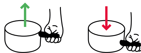
Le poids est perçu différemment selon le centre de gravité de l'objet, le positionnement des poignées et l'inclinaison des bras lors de l'action.
