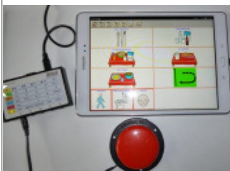
Contacteur branché sur interface Hitch connectée à la tablette via adaptateur OTG (USB On The Go)
