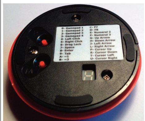
Face arrière : boutons de programmation et fonctions programmables
